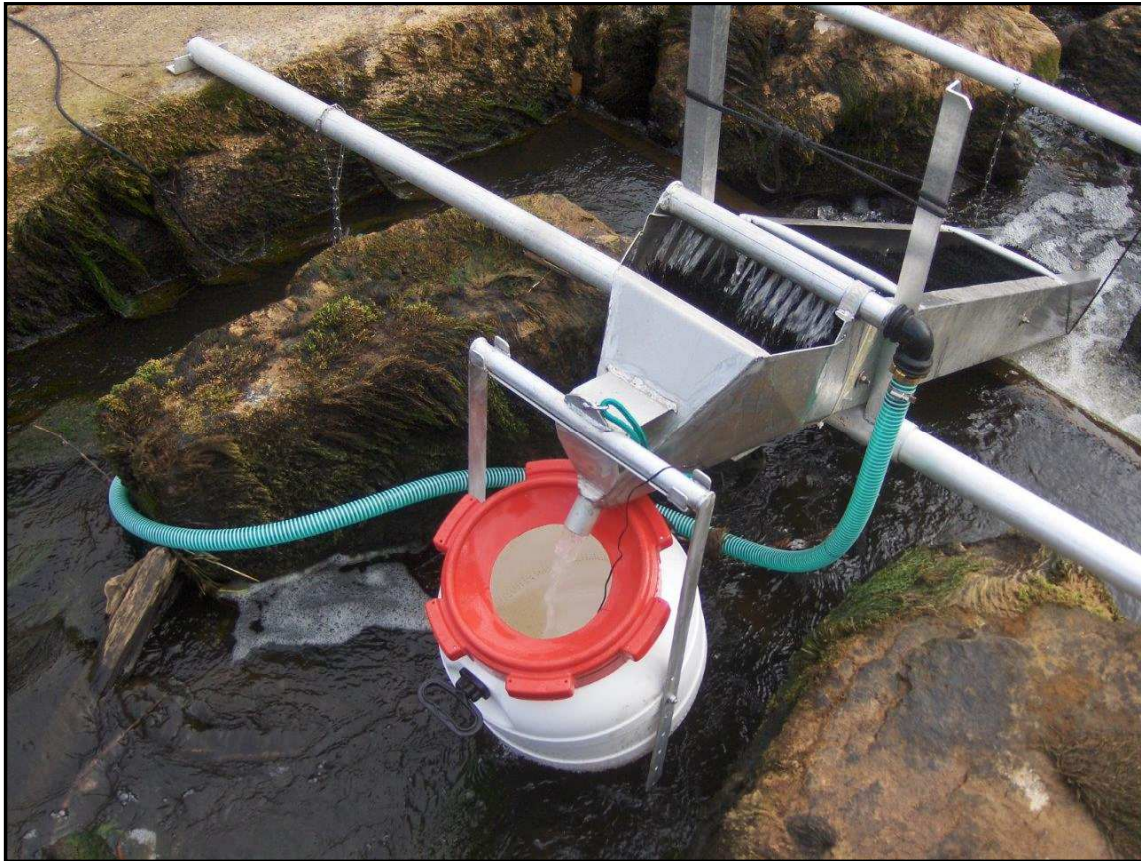
Abbildung 8: Aalleiter in Funktion. Im Vordergrund ist der Auffangbehälter inkl. Wasserversorgung erkennbar (Quelle: Landesfischereiverband Weser-Ems).
