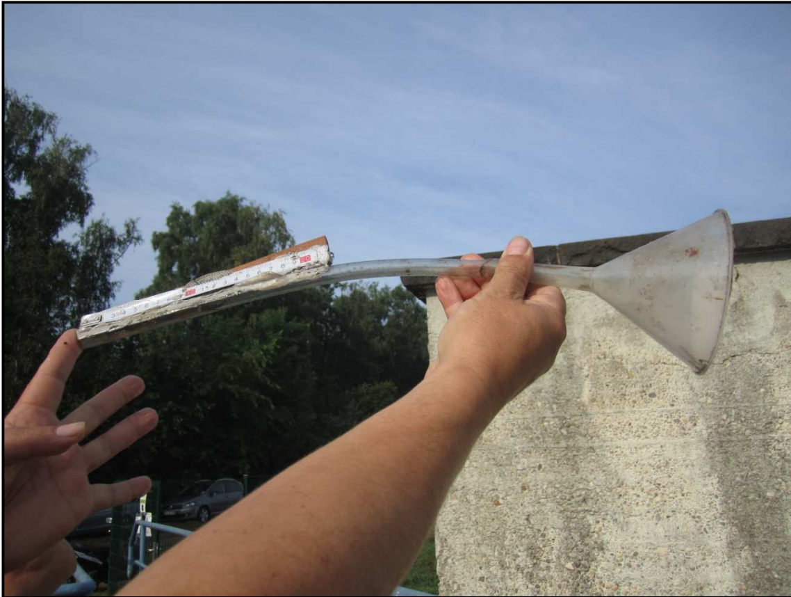
Abbildung 9: Messeinrichtung für kleine Aale (Quelle: Landesfischereiverband Weser-Ems).
