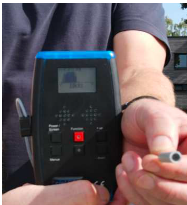
Abb. 2: Ultraschalldetektor mit Richtmikrofon (Foto: B. Weise)
